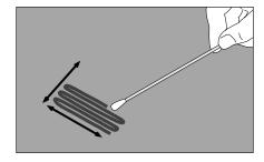
2 Sostener el swab en un ángulo de 30° con respecto a la superficie a muestrear. Frotar el swab lenta y completamente por toda la superficie del área deseada. Repetir esta operación tres veces sobre esta superficie, en tres direcciones distintas
