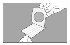
Usando una Placa Petrifilm<sup>™</sup>hidratada, levantar cuidadosamente el film superior. Evitar tocar el área de crecimiento circular. El gel se adhiere al film superior
