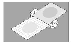
2 Sin tocar el área circular de crecimiento, levantar el film superior y llevarlo hacia atrás hasta que quede adherido a la cinta adhesiva. Asegurarse que el film quede plano sobre la pinza
