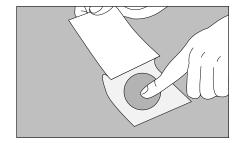
2 Contactar la porción del gel situada en el film superior con la superficie a analizar. Frotar con los dedos la parte exterior del área gelificada para asegurar un buen contacto con la superficie. Como con cualquier sistema de control de este tipo, lo mejor es limpiar la superficie tras el contacto para remover cualquier residuo
