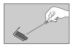
Sostener el swab en un ángulo de 30° con respecto a la superficie a muestrear. Frotar el swab lenta y completamente por toda la superficie del área deseada. Repetir esta operación tres veces sobre esta superficie, en tres direcciones distintas
