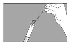
1 Vaciar 5 mL de la solución de enjuague en pequeños tubos con tapón de rosca y autoclavearlos Humedecer la cabeza del swab y exprimir la solución en exceso presionando contra la pared interior del tubo con un movimiento rotatorio
