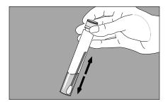
3 Regresar el swab al interior de la solución de enjuague en el tubo, y romperlo de la parte superior. Cerrar el tubo y agitar vigorosamente por 10 seg. Inocular cada Placa Petrifilm<sup>™</sup> con 1 mL de la solución.
