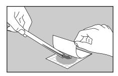
9 Vaciar cuidadosamente el contenido del tubo sobre una Placa 3M Petrifilm™ o 3M Redigel™
