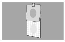
3 Se puede usar la cinta adhesiva de doble cara con ó sin la pinza para posicionar las Placas Petrifilm para muestreo de aire Exponer las Placas Petrifilm por no mas de 15 minutos.
