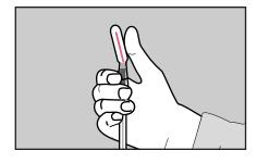
2 En el lugar del muestreo, preparar el swab sosteniéndolo con el bulbo cerca de su dedo pulgar. Presionar los lados del bulbo y doblar a un ángulo de 45 ° hasta que se escuche que se rompe la válvula. Esto permite que el caldo letheen fluya al interior del tubo y moje el swab.
